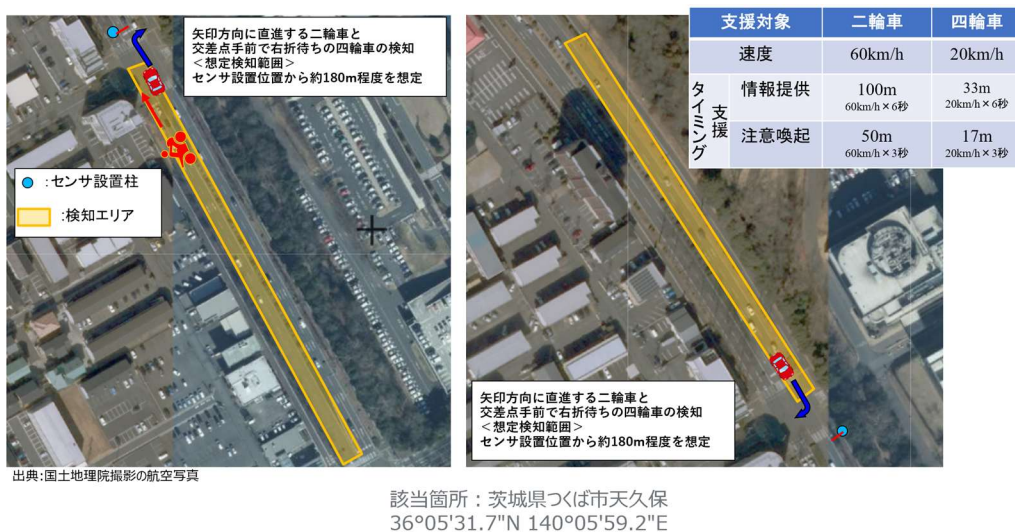
図 2.4-25 UC② センサ設置・検知イメージ
