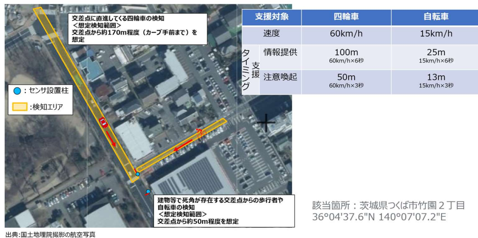
図 2.4-21 UC1-1 センサ設置・検知イメージ①
