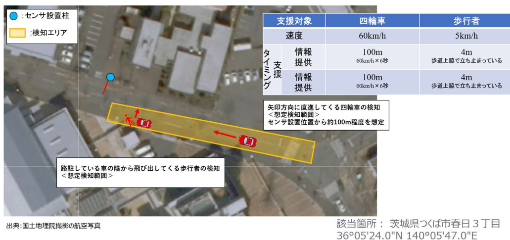
図 2.4-23 UC①-2 センサ設置・検知イメージ①
