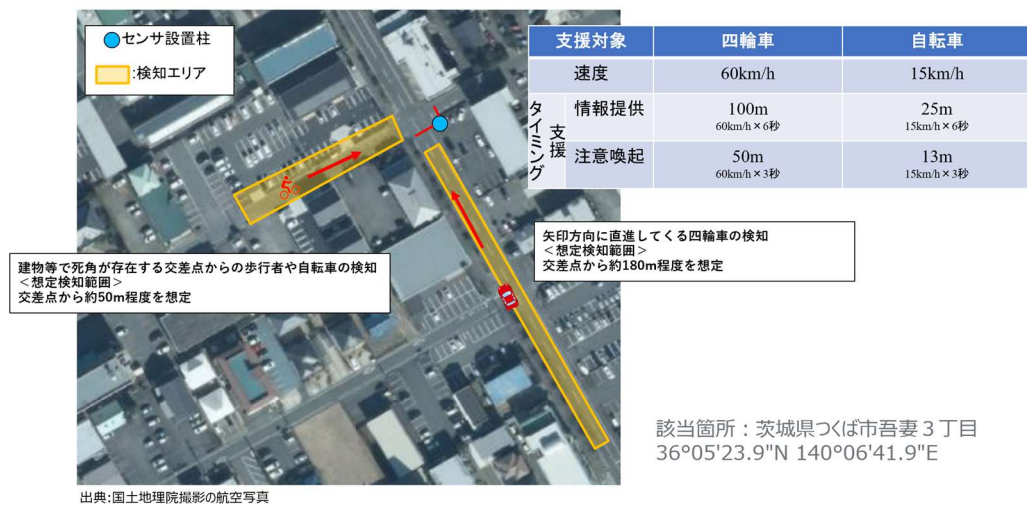
図 2.4-22 UC①-1 センサ設置・検知イメージ②
