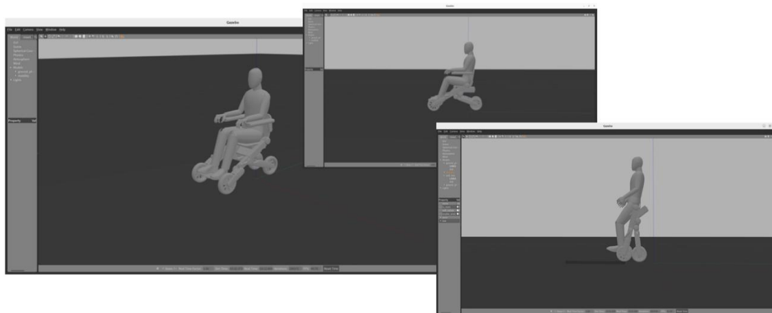
物理シミュレータ (Gazebo, ROS2) : 床との摩擦、乗り越え段差、制動距離等の検証や、実トルクでの変形機能の確認等
