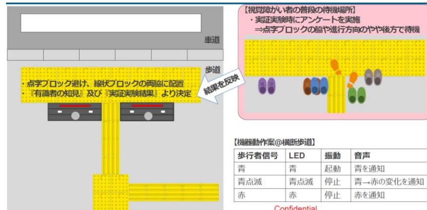
薄型トラフユニット設置イメージ@横断歩道
