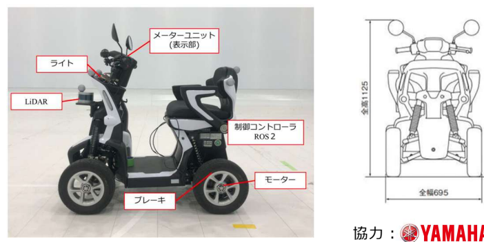
図. 最高速度制限 10km/h とするために再設計されたパーソナル・モビリティ
