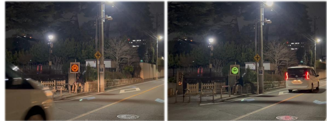
夜間も車両を検知している速度計測表示機
