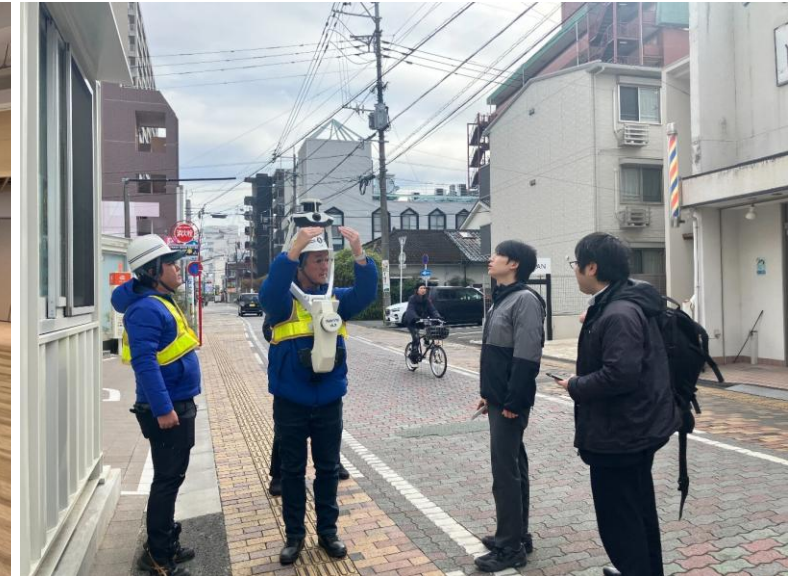
▼対象道路の3D点群測量の様子
