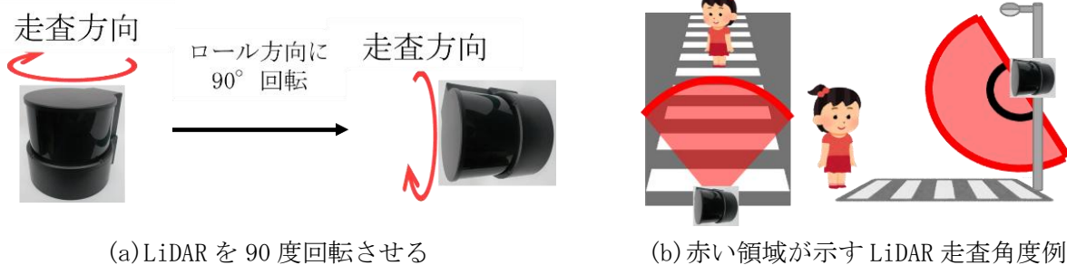
図 3.1.3 インフラセンサとして設置直下も観測可能な機械式広 FOV 型 PCSEL-LiDAR の設置例
