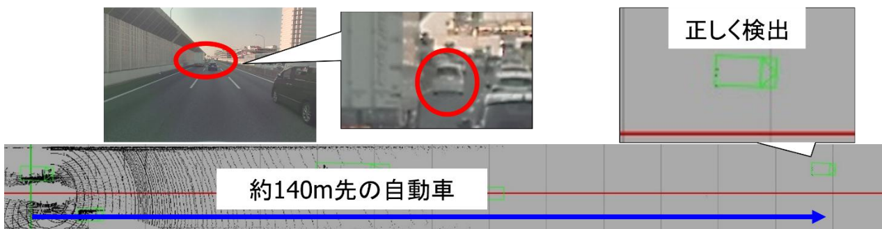
図 3.1.15 開発した認識モデルが遠距離まで認識が可能な様子
