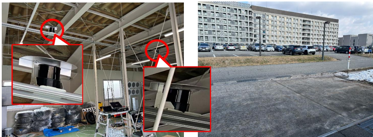
図 3.2.1 試作の実機機械式広 FOV 型 PCSEL-LiDAR とその設置場所（左図）
