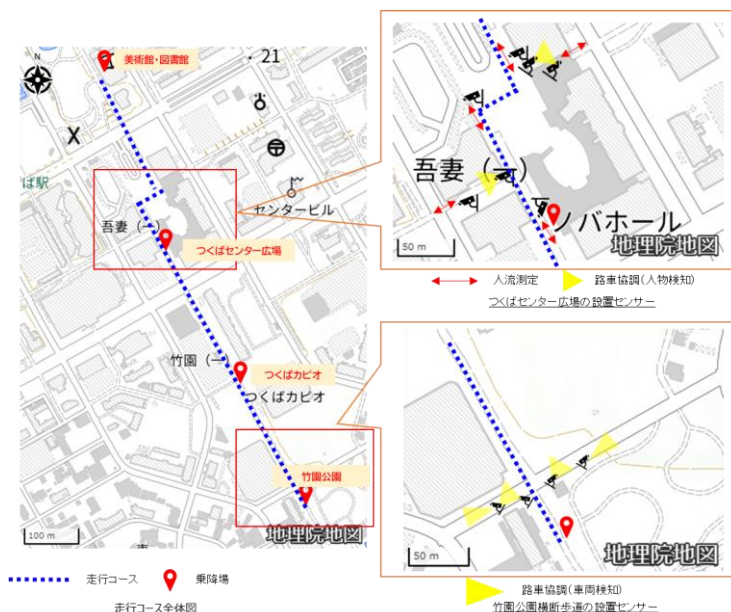
図 6-4 走行コースとインフラセンサ設置箇所
