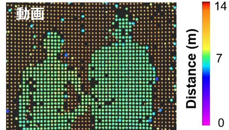
**2次元SPADとPCSELを用いた3次元測距の初期評価に成功
